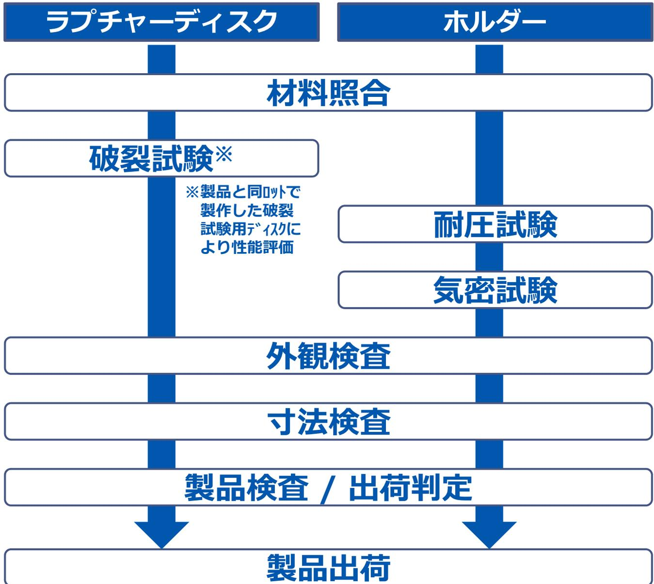
ご要望いただけましたら、Heリーク試験、非破壊試験、クリーンルームでの組立・梱包・超音波洗浄も対応が可能です。
